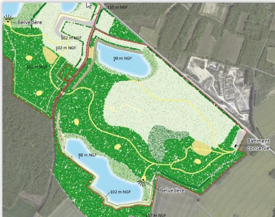
Figure 5 : Principe de remise en état dans le cadre du projet
